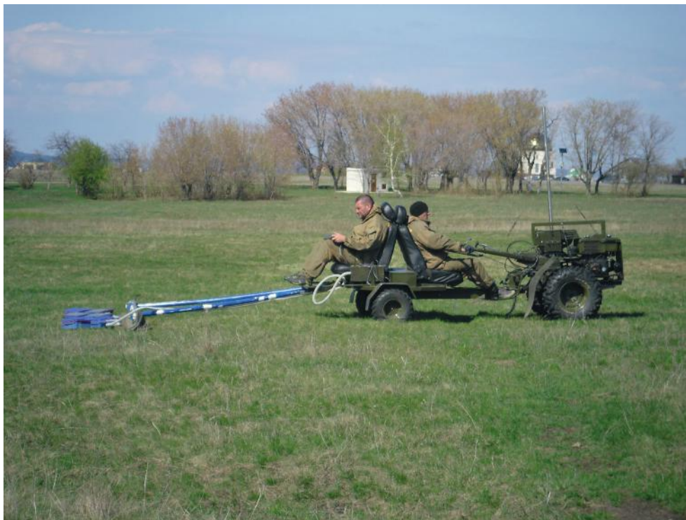
Рис. 3. Рабочий момент георадарных исследований многоантенным георадарным комплексом MARK 300-8.
