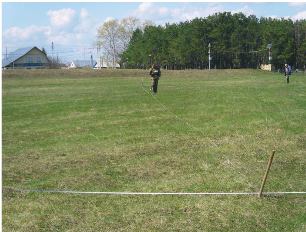
Рис. 1. Рабочий момент магнитометрических исследований градиентометром POS-2.
