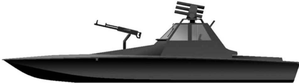
Рисунок малого катера, вооруженного установкой для запуска турбореактивных снарядов калибра 107 мм
