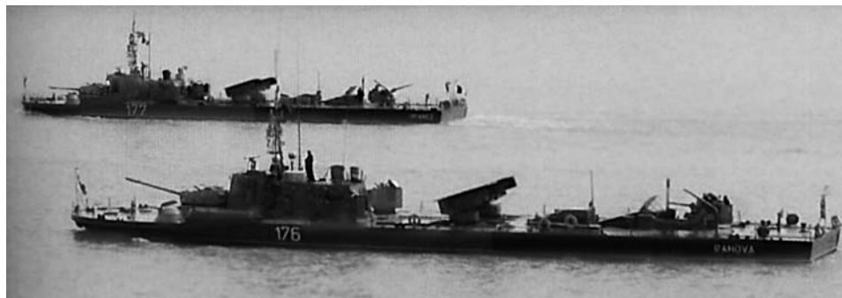
Румынские речные катера с установками для стрельбы реактивными снарядами калибра 122 мм. Вероятно, использованы установки А-215
