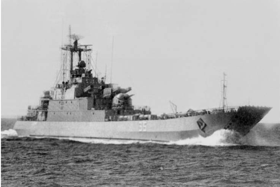
Две установки А-215, смонтированные на десантном корабле Hoyerwerda, построенном в ГДР
