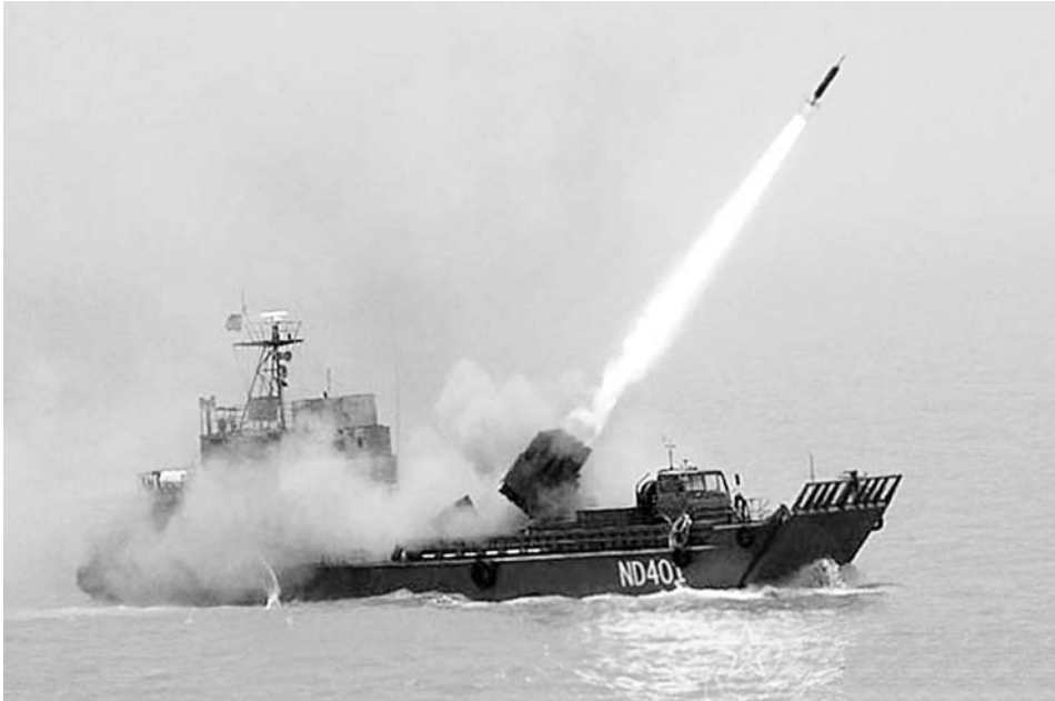
Боевые машины на модифицированном шасси грузового автомобиля North Benz ND-1260 6 × 6 на палубе малого десантного корабля
